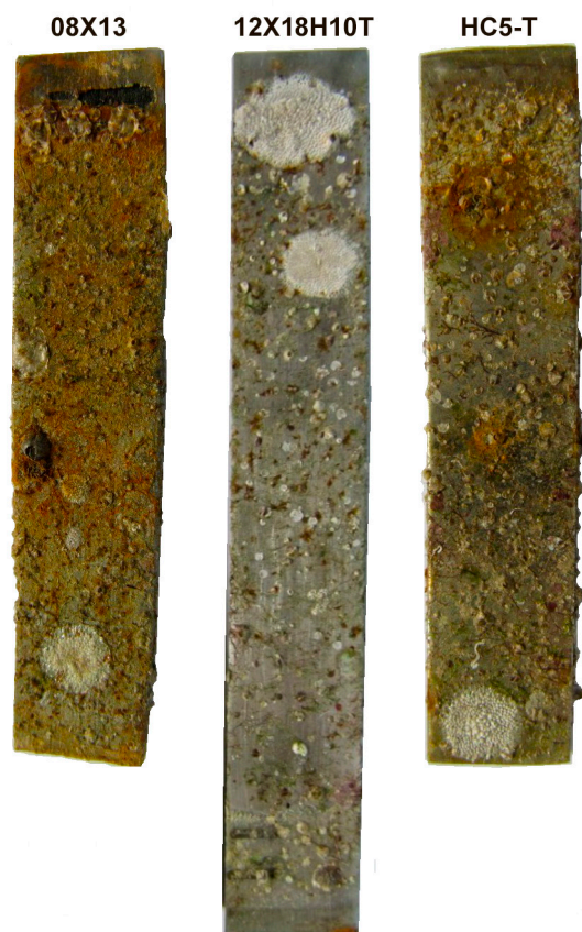
Рис. 6. Внешний вид поверхности сталей 08X13, 12X18H10T и HC5-T после 30 сут выдержки в морской воде
