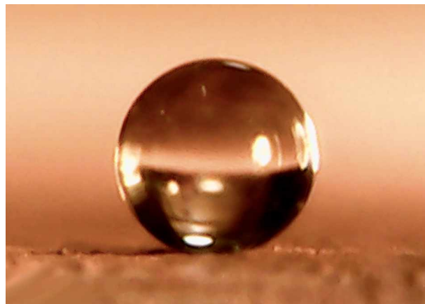
Рис. 3. Капля на супергидрофобном дендритном медном покрытии: 0,25 \text{ A/cm}^2 , 50 \text{ с} , стеариновая кислота
