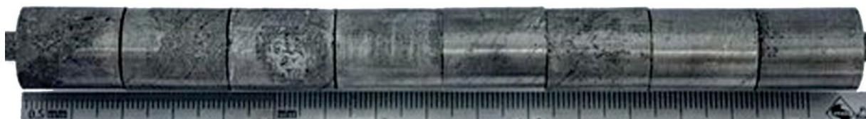
Рис. 8. Фотография кассеты № 3. Кальчинское месторождение, ТССН, 2018 г. КР = 0,0175 г/(м<sup>2</sup>·ч), скорость локальной коррозии, рассчитанная по формуле (1) – 1,1738 мм/год
