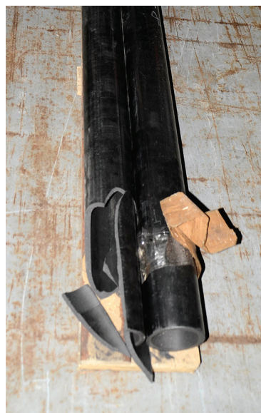
Рис. 2. Разрушение АЗ при транспортировке Fig. 2. Anode destruction during transportation
