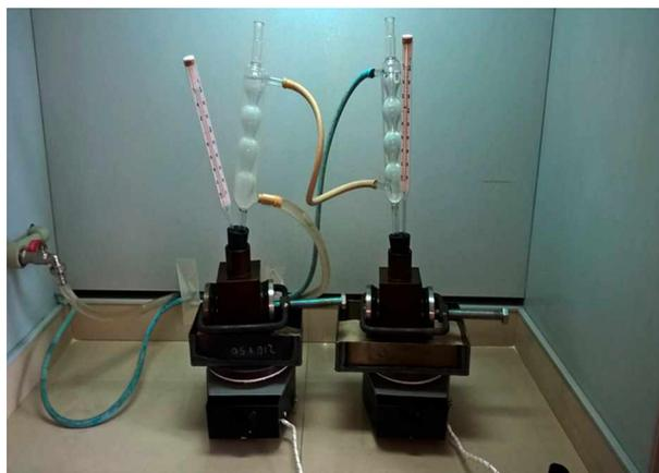
Рис. 1. Установка для определения химической стойкости методом кипячения
