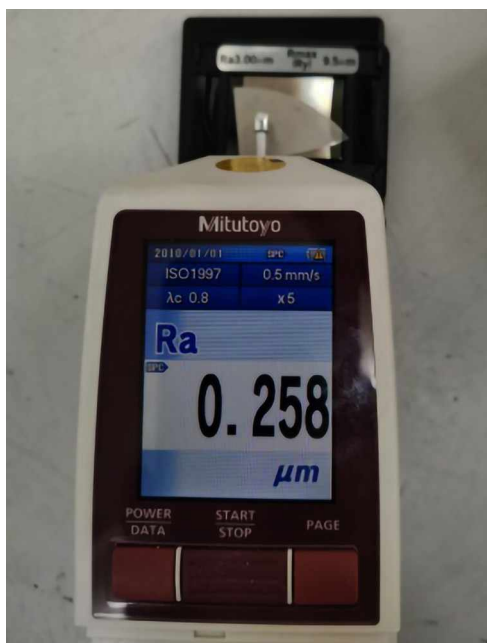
Рис. 4. Шероховатости: а – лезвийно-обработанной пластины, б – полированной стороны пластины сапфира
