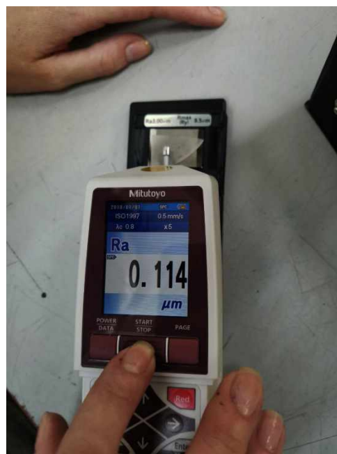
Рис. 4. Шероховатости: а – лезвийно-обработанной пластины, б – полированной стороны пластины сапфира
