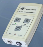
Регистратор ИР-2М с возможностью измерения поляризационного потенциала
