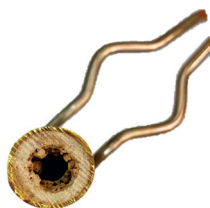
Рис. 1. Латунная трубка теплообменника с отложениями
