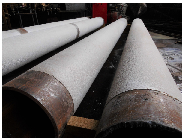
Трубы с наружным антикоррозионным покрытием МПП
