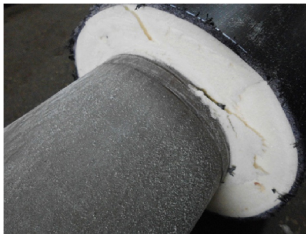
Трубы с наружным антикоррозионным покрытием МПП под ППУ-изоляцией
