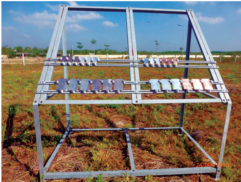
Рис. 1. Внешний вид станда с образцами для определения коррозивности атмосферы КИС Кон Зо после постановки на натурные испытания
