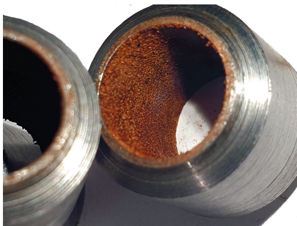
Рис. 3. Вид образцов после коррозионных исследований с добавлением 0,5 % воды Fig 3. View of samples after corrosion studies with addition of 0.5% water
