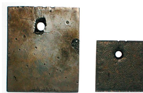
**Рис. 7. Внешний вид образцов композитов после испытаний в кипящем растворе серной кислоты с массовой концентрацией 60%, продолжительностью 1000 часов.**
