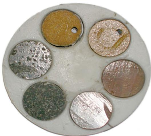
**Рис. 8. Внешний вид фторопластового держателя с установленными в нем образцами композитов для испытаний в динамических условиях**
