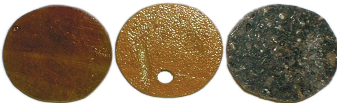
**Рис. 9. Внешний вид образцов композитов после испытаний в динамических условиях в пульпе серной кислоты с массовой концентрацией 5% и кварцевого песка при соотношении твердой фазы и жидкости 1:2, температуре 100 °С, скорости потока 1 м/сек и продолжительности 100 часов.**
