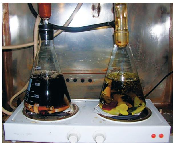
**Рис. 1. Внешний вид установки для проведения статических испытаний образцов композитов в водных растворах при кипении**
