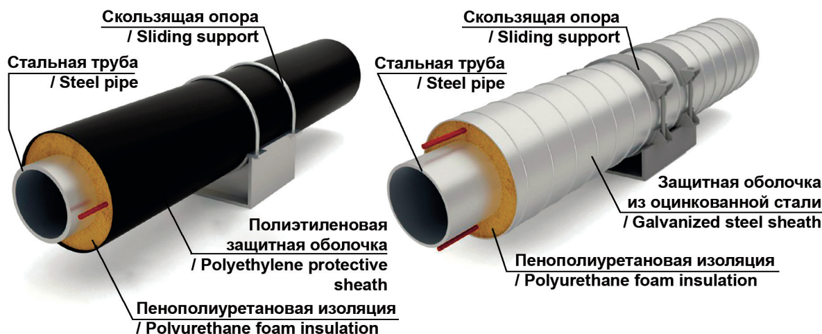
Рис. 1. Общий вид предизолированных труб в ППУ изоляции
