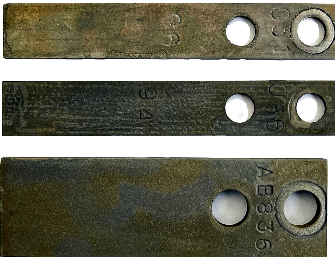
Рис. 3. Внешний вид образцов контроля коррозии после 208 ч испытаний (эксперимент 2), сверху вниз: сталь 13ХФА, 09Г2С, AISI 1018
