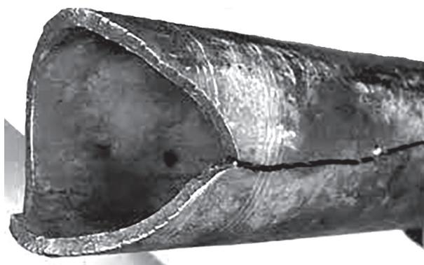
**Рис. 2. Растрескивание НКТ в среде скважин, содержащих сероводород**
