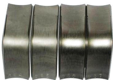
Рис. 3. Внешний вид образцов, исследованных методом изгиба, с провоцирующим нагревом (а, б) и в обычном состоянии (с, д) после испытаний на стойкость против МКК
