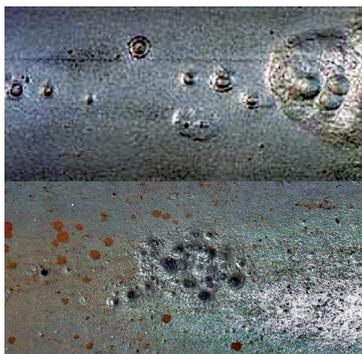
Рис. 10. Микробиологическая коррозия насосно-компрессорной трубы (сверху) и трубопровода системы ППД (снизу) под слоем адгезированных СВБ
